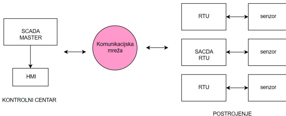
Slika 1. Blokovski shematski prikaz SCADA sustava
