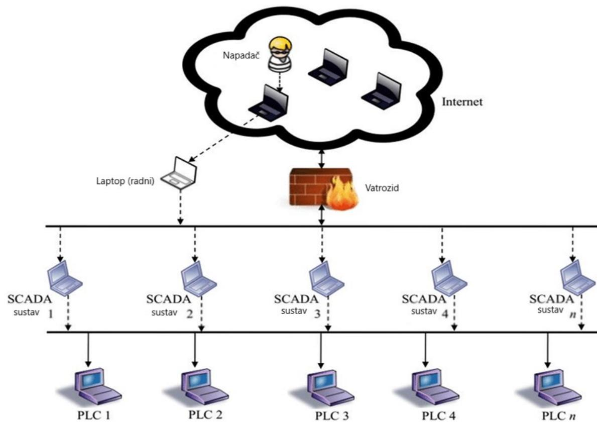
Slika 11. Primjer napada na SCADA sustav [14]
