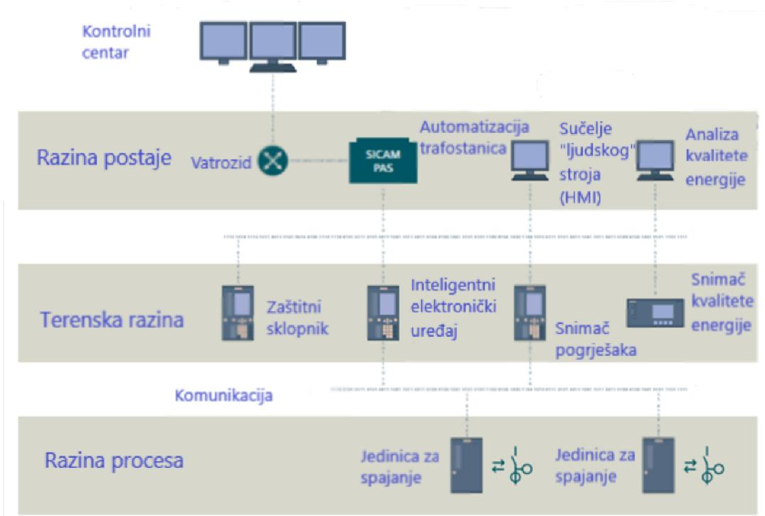
Slika 6. Prikaz načina funkcioniranja SCAM PASS sustava [7]
