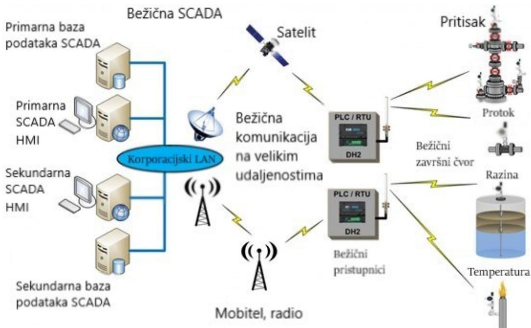
Slika 9. Prikaz primjera primjene SCADA sustava [10]
