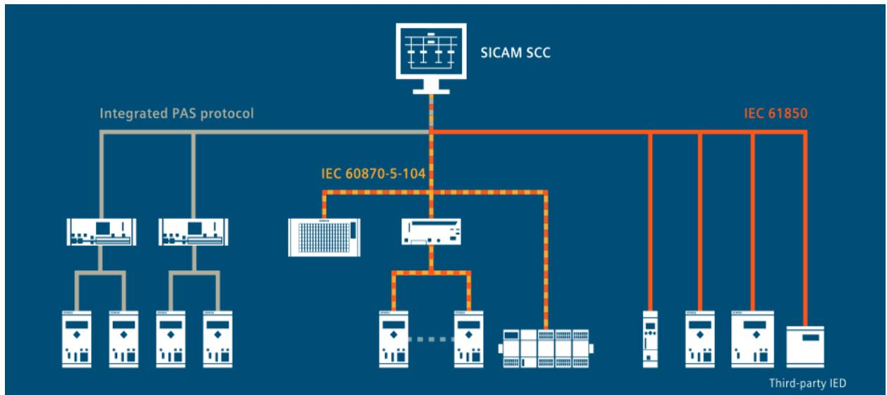
Slika 7. Prikaz načina funkcioniranja SCAM SCC sustava [8]
