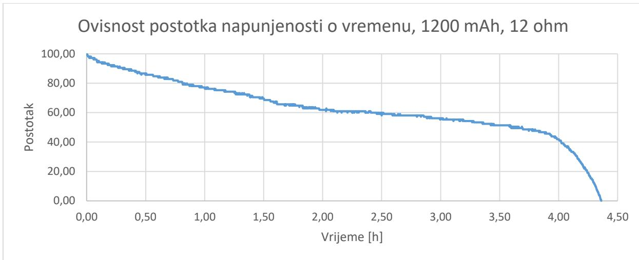
**Slika 3.8.** Ovisnost postotka napunjenoosti o vremenu kod baterije 1200 mAh, koristeći otpornik od 12 ohm-a.
