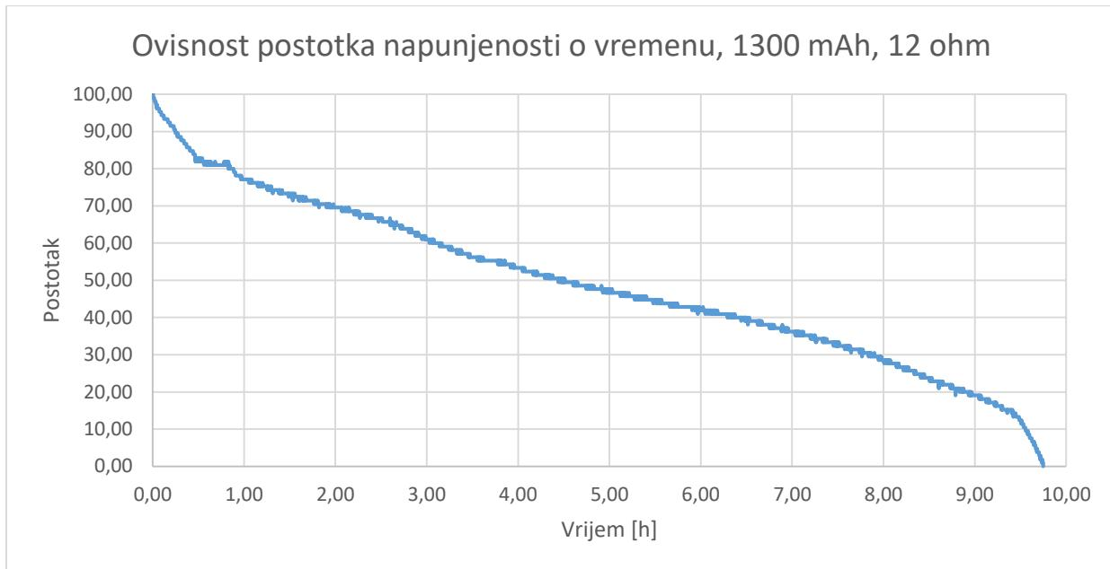
**Slika 3.12.** Ovisnost postotka napunjenoosti o vremenu kod baterije 1300 mAh, koristeći otpornik od 12 ohm-a.
