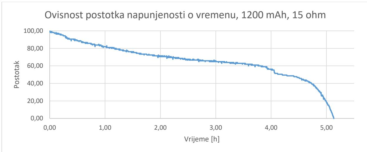
**Slika 3.10.** Ovisnost postotka napunjenoosti o vremenu kod baterije 1200 mAh, koristeći otpornik od 15 ohm-a.
