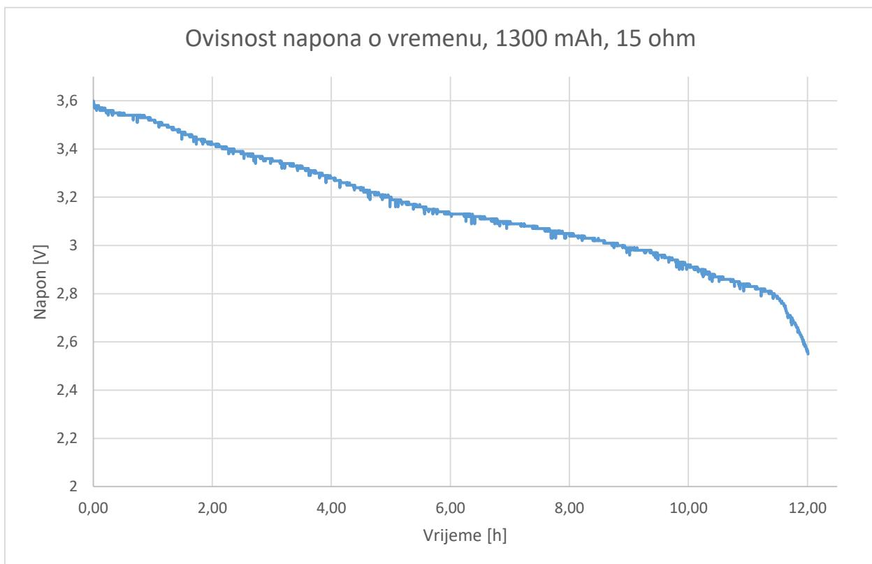
**Slika 3.13.** Ovisnost napona o vremenu kod baterije 1300 mAh, koristeći otpornik od 15 ohm-a.
