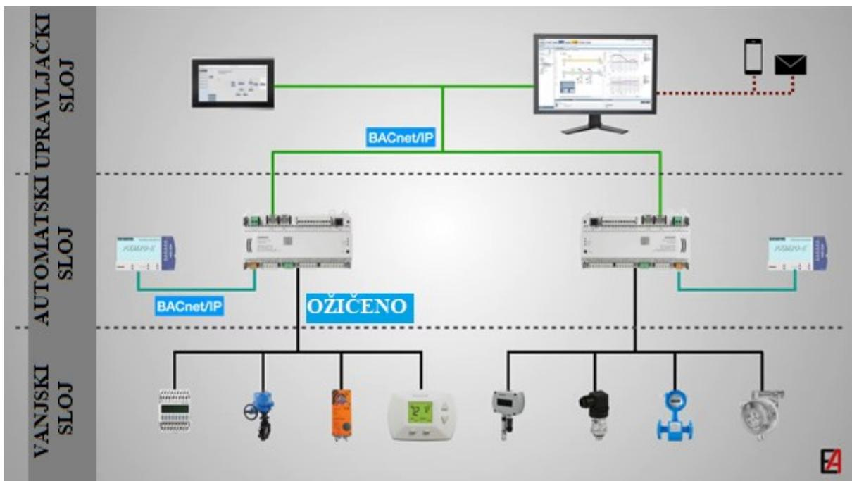
Slika 3.2. Prikaz spajanja uređaja po slojevima [7]
