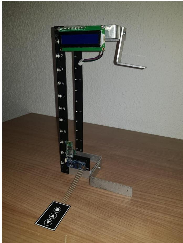
*Slika 4.4. Nova izvedba makete s mikroupravljačkim sustavom*
