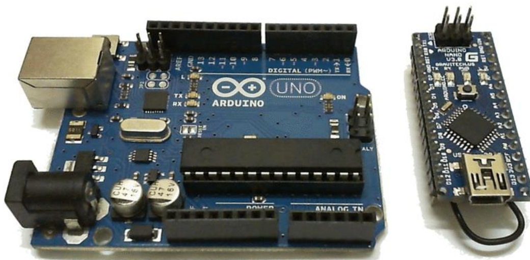
Slika 2.1. Arduino UNO pločica (lijevo) i Arduino Nano pločica (desno)
