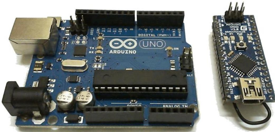
Slika 2.1. Arduino UNO pločica (lijevo) i Arduino Nano pločica (desno)
