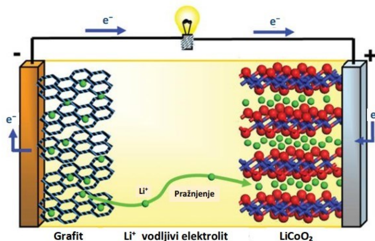
Slika 4.2. Shematski prikaz litij-ionske baterijske ćelije [12]
