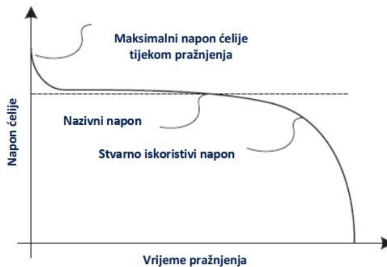
Slika 3.3. Karakteristika naponskog pražnjenja baterijske ćelije [12]
