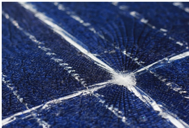
Slika 4.8. Pucanje stakla fotonaponske ćelije [23]
