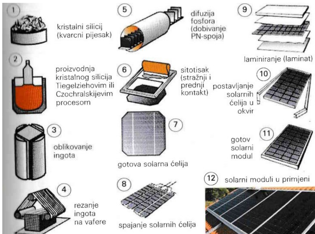
Slika 3.4. Postupak proizvodnje fotonaponskih ćelija i fotonaponskog modula [4]
