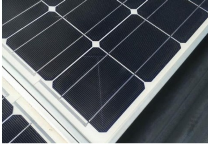
Slika 4.7. Pucanje stanice u ćeliji [22]
