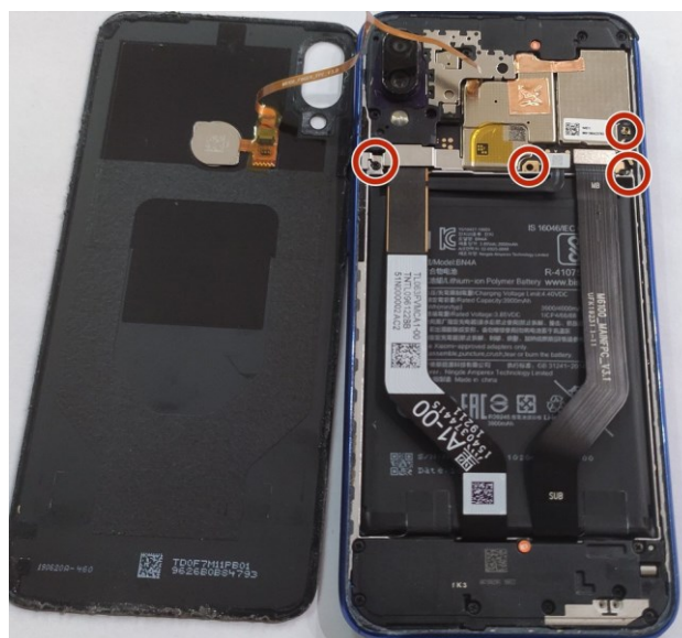
Sl. 5.1.1. Unutrašnjost Xiaomi Redmi Note 7 pametnog telefona [20]
