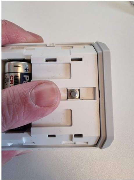
Sl. 5.1.2. Prikaz sklopke koja se nalazi u unutrašnjosti senzora pokreta [21]
