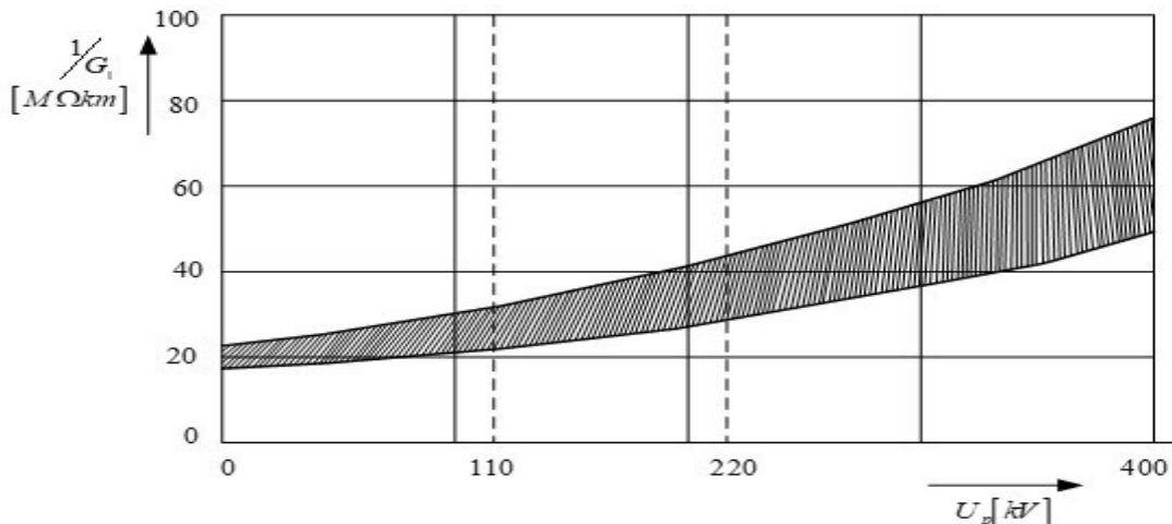
Slika 3.5. Ovisnost recipročne vrijednosti odvoda vodiča ili snopa po jednici dužine voda ( $1/G_1$ ) o pogonskom naponu ( $U_p$ ) [15]
