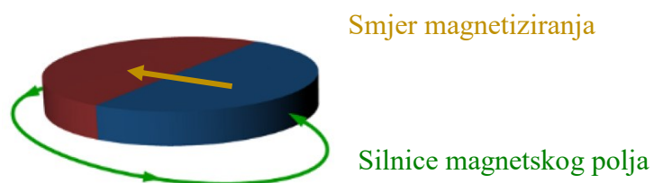
Slika 5.16. Radijalno magnetiziran magnet [22]
