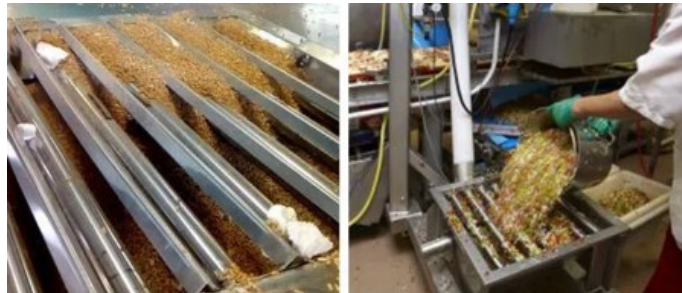
Slika 5.8. Primjena rešetkastih separatora u lijevku [11]
