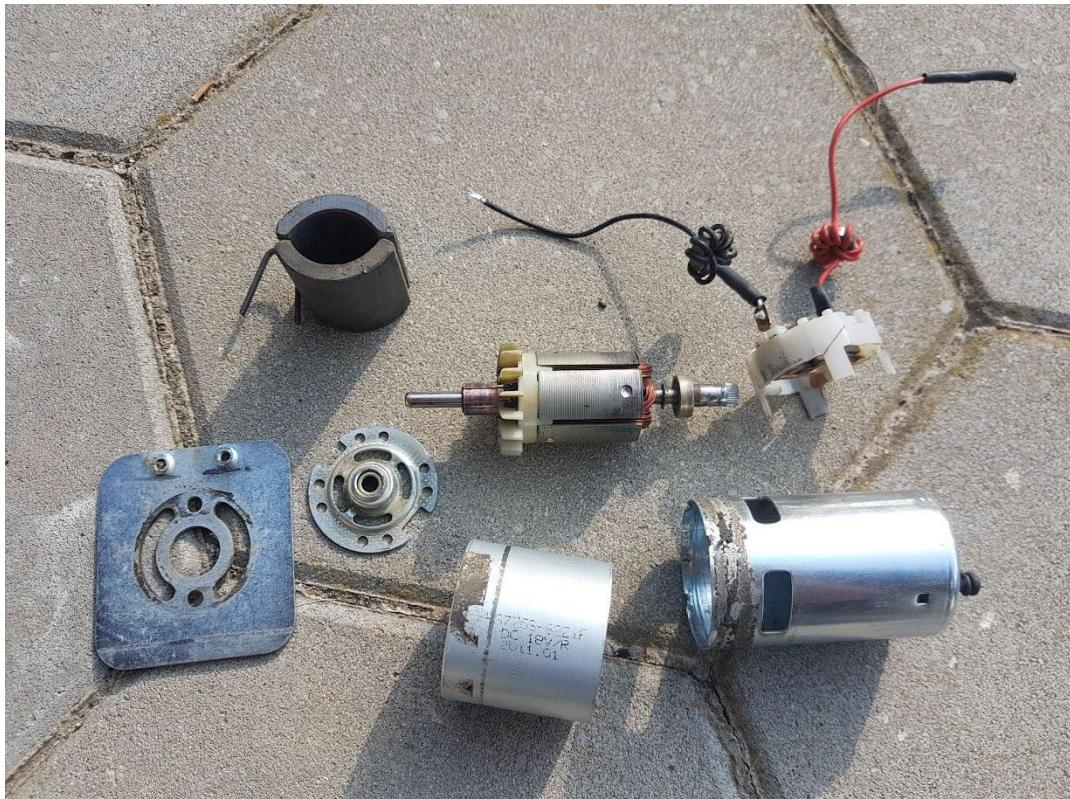
Sl. 5.5. Rastavljeni električni motor promatranog trimera
