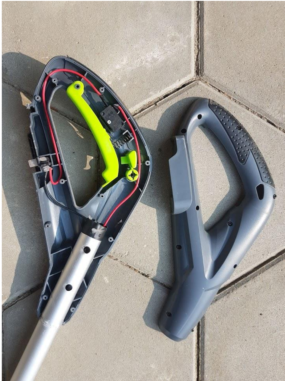
Sl. 5.4. Prikaz rastavljene ručke električnog trimera
