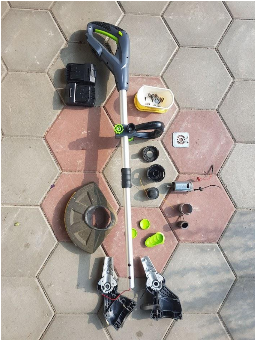
Sl. 5.2. Postupak rastavljanja električnog trimera
