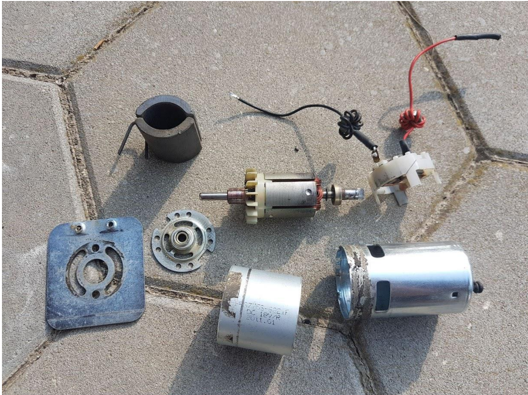
Sl. 5.5. Rastavljeni električni motor promatranog trimera
