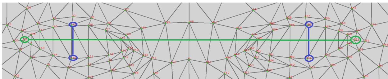
Slika 3.3. Dužine potrebne za detekciju zatvorenosti očiju
