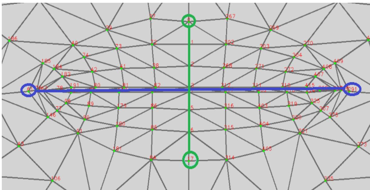
Slika 3.4. Dužine potrebne za detekciju zatvorenosti očiju
