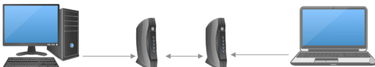
SL. 2.3: Topologija mreže od točke do točke s dva računala i modemima
