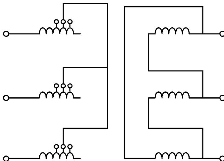
**Slika 3.3.** Shematski prikaz transformatora s ručnom preklopkom (transformator s odvojcima) [9].
