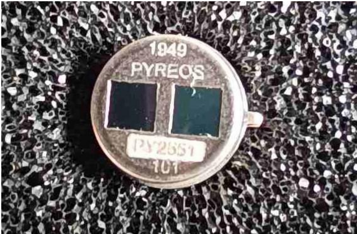
Sl. 4.1. PY 2551 piroelektrični senzor korišten u izvedbi uređaja
