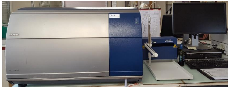
Sl. 2.1. Laboratorijski instrument za mjerenje parametara vina tvrtke Foss, model WineScan TM SO 2 .
