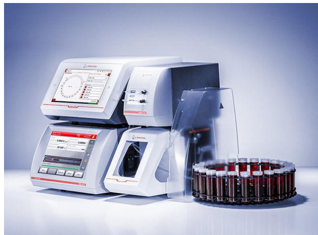
Sl. 2.5. Laboratorijski instrument za mjerenje parametara vina, Lyza 5000 Wine tvrtke Anton Paar
