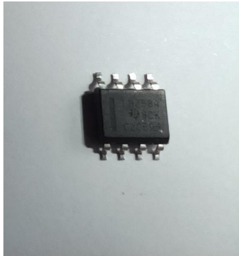
Sl. 4.3. LM258A operacijsko pojačalo
