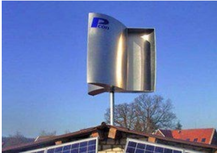
Slika 2.1.3. Primjer Savonius turbine [5]
