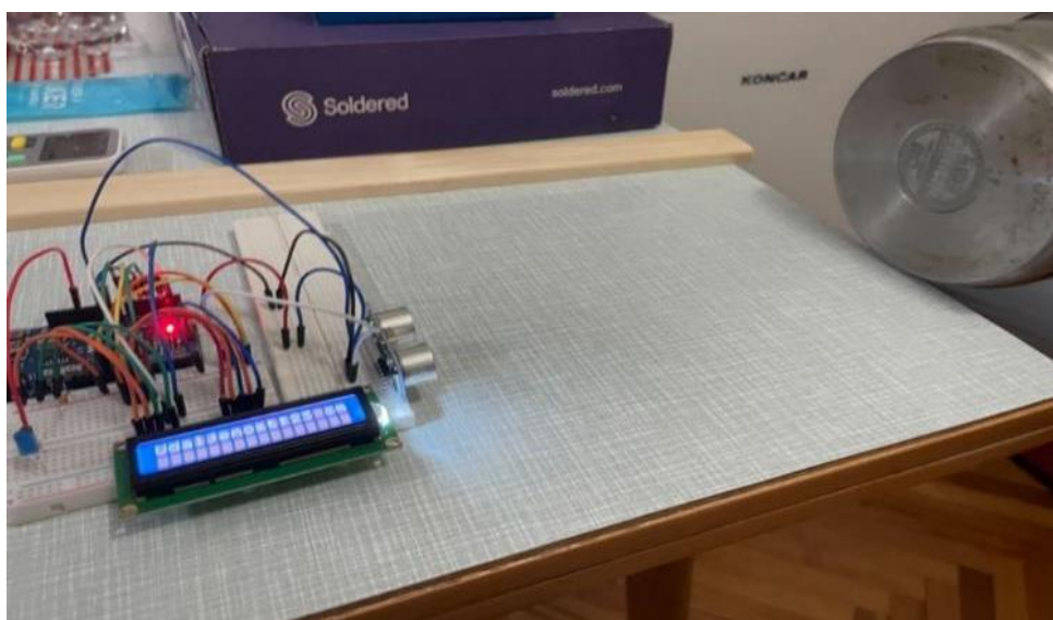
Slika 4.24. Prikaz mjerenja udaljenosti od objekta metalne površine
