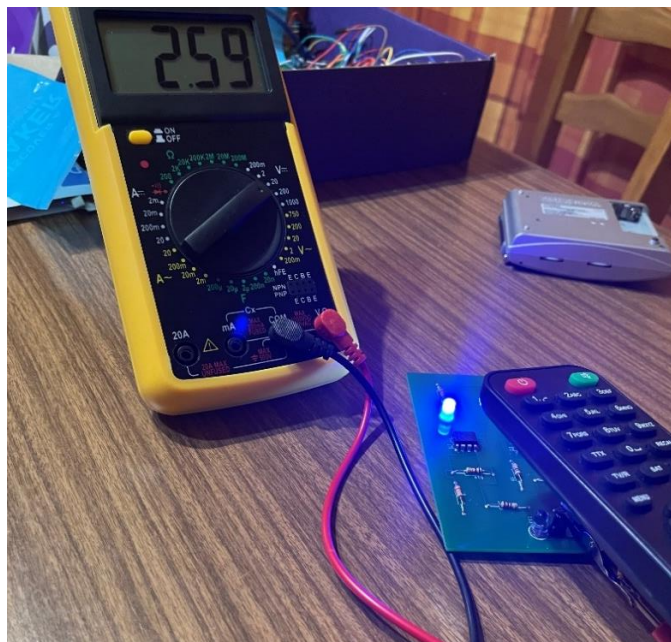
Slika 4.15. Prikaz mjerenja usporednog napona pri detekciju plastičnog objekta crne boje na udaljenosti od 7 cm uz iluminaciju jedne LED diode
