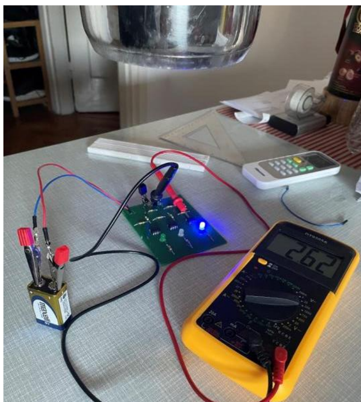
Slika 4.17. Detekcija metalne površine objekta na udaljenosti od 27 cm
