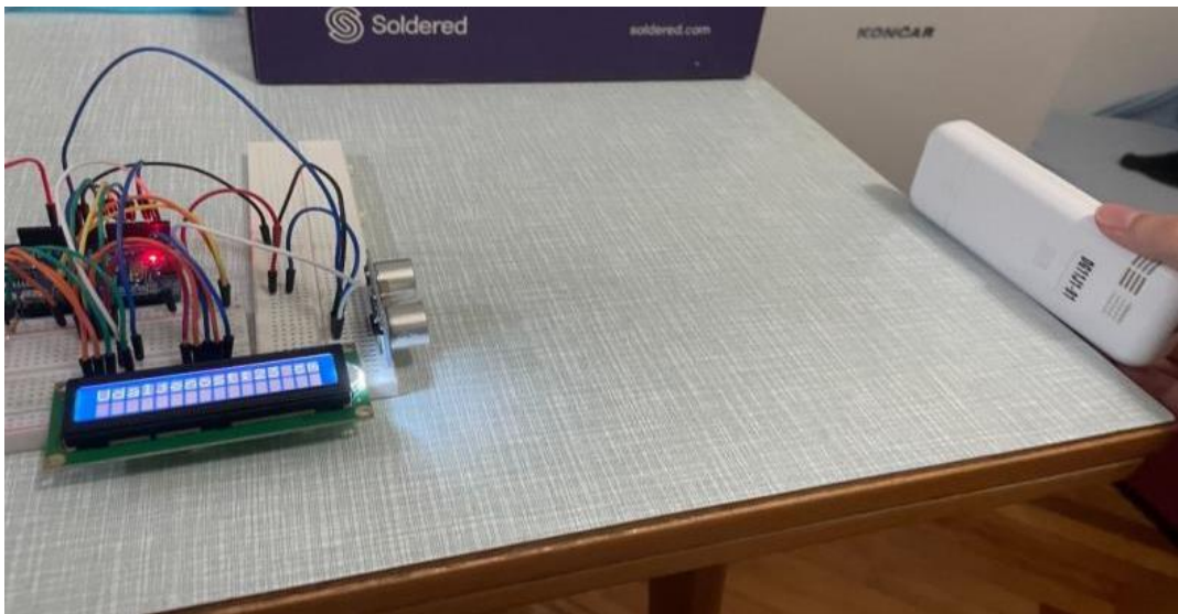
Slika 4.22. Prikaz mjerenja udaljenosti objekta plastične površine
