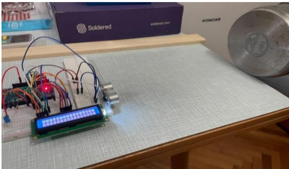
Slika 4.24. Prikaz mjerenja udaljenosti od objekta metalne površine
