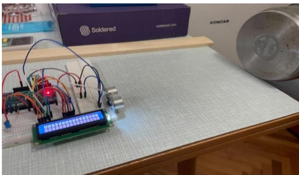
Slika 4.24. Prikaz mjerenja udaljenosti od objekta metalne površine
