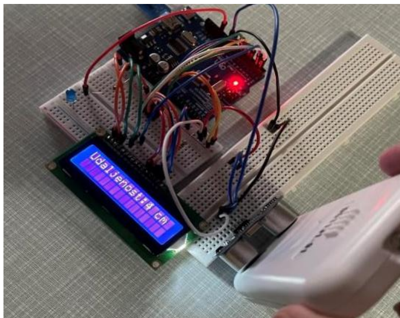
Slika 4.27. Mjerenje i prikaz mjernog rezultata na udaljenosti manjoj od 1 cm
