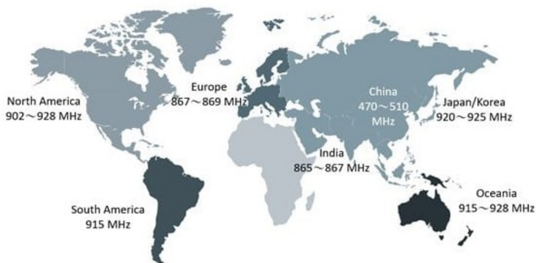
Slika 3.1. Frekvencijski pojasevi za LoRa tehnologiju [7]
