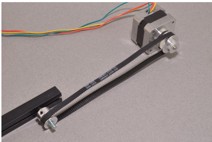
Slika 3.3. Pojednostavljena petlja pisača s GT2 remenom [9]
