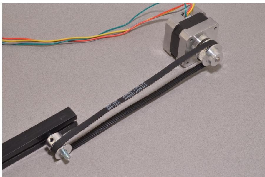
Slika 3.3. Pojednostavljena petlja pisača s GT2 remenom [9]
