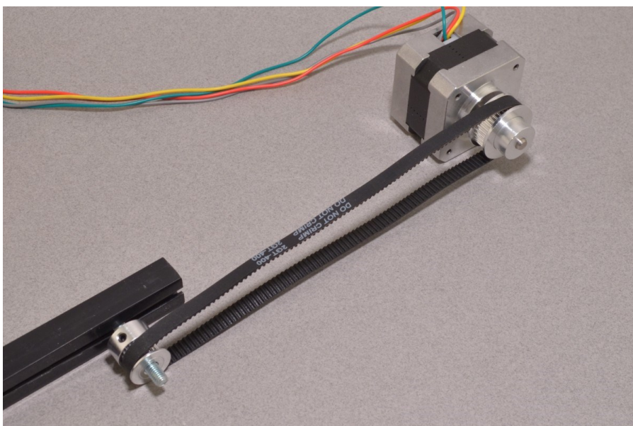
Slika 3.3. Pojednostavljena petlja pisača s GT2 remenom [9]
