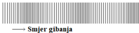
Slika 3.1. Prikaz longitudinalnog vala
