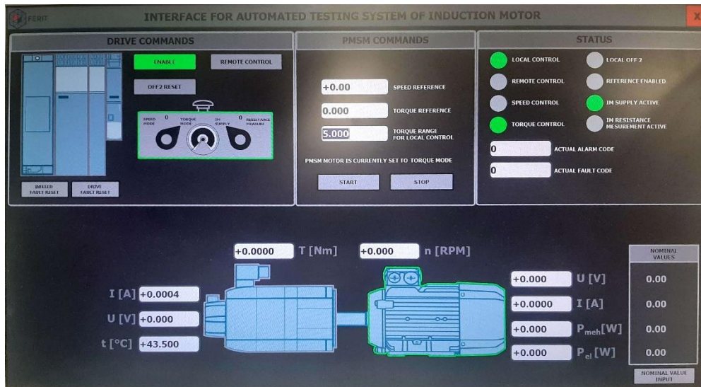
Slika 4.7. Računalno sučelje za automatizirano testiranje asinkronog motora
