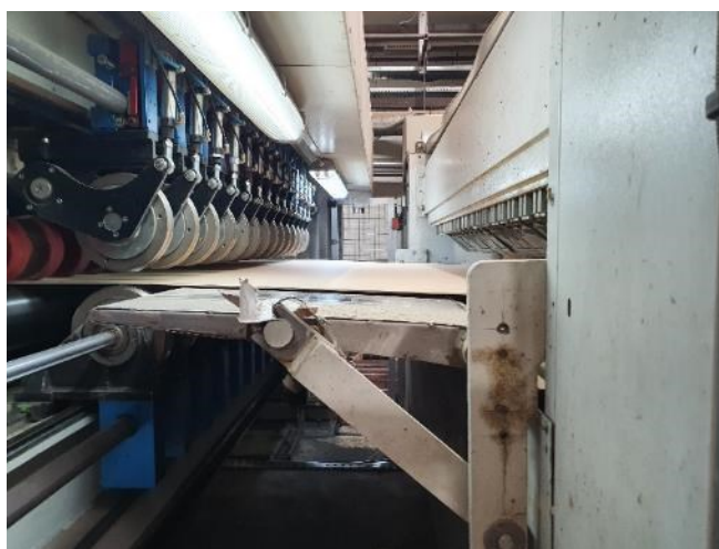
Slika 4.10. Rilovi za žlijebljenje kartona (fotografirano 9. kolovoza 2022.)
