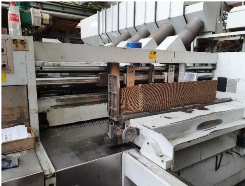
Slika 4.20. Ulagač Martin 924 (fotografirano 9. kolovoza 2022.)
