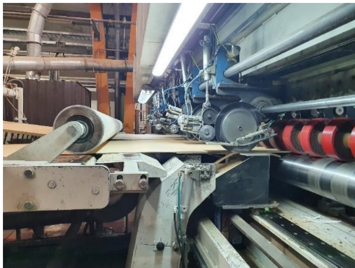
Slika 4.11. Noževi za uzdužno rezanje (fotografirano 9. kolovoza 2022.)
