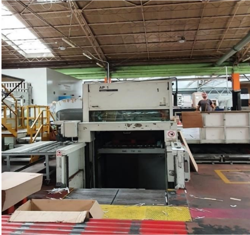
Slika 4.19. Dizalo sa paletom za slaganje štancanih ploča Bobst 1600 (fotografirano 9. kolovoza 2022.)
