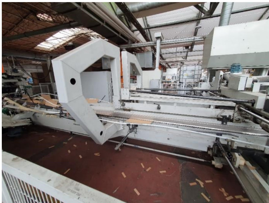
Slika 4.22. Stanica za savijanje i lijepljenje Martin 924 (fotografirano 9. kolovoza 2022.)
