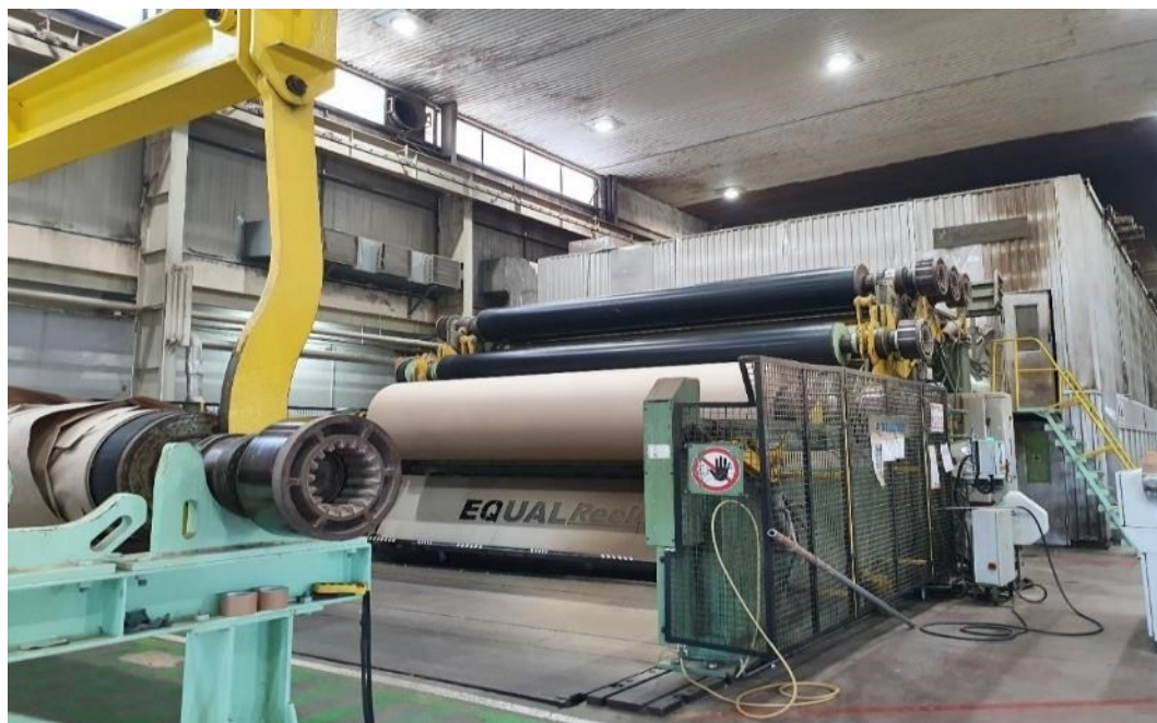
Slika 3.8. Namatač (fotografirano 20. lipnja 2022)
