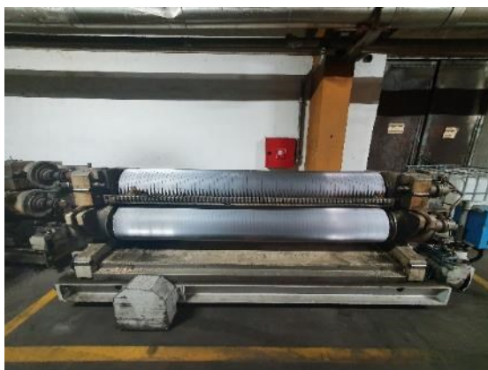
Slika 4.7. Rebrasti valjci pripremljeni za ubacivanje u stroj (fotografirano 9. kolovoza 2022.)
