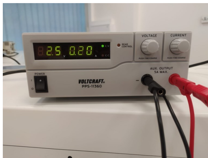
Slika 8.5. Izvor napajanja „Voltcraft PPS-11360“
