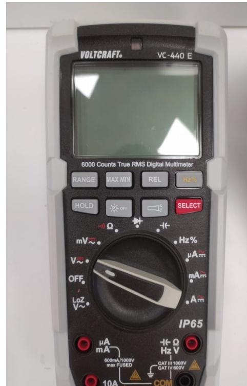
Slika 8.4. Univerzalni mjerni instrument „Voltcraft VC-440 E“
