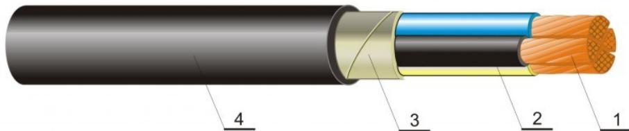
Slika 3.1. Prikaz konstrukcije niskonaponskog energetskog kabela [9]
