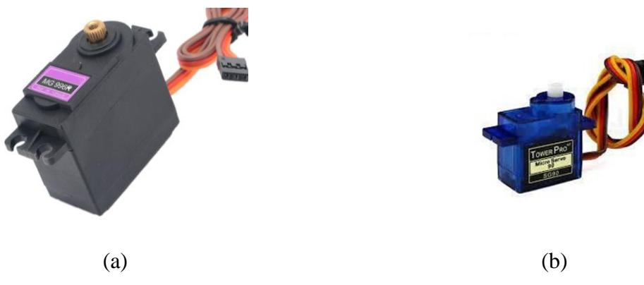
Sl. 3.2. Korišteni servo motori: (a) MG996R i (b) SG90 Micro.
