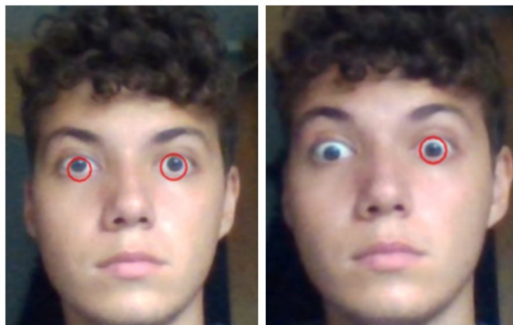
Slika 4.6. Detekcija očiju s jednostavnom binarizacijom.
