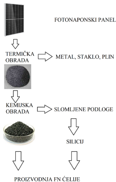
Slika 5.1. Prikaz tehnološkog postupka recikliranja fotonaponskog panela na bazi silicija
