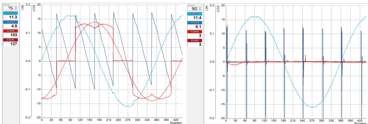
Slika 4.22. Valni oblici struje izvora i osnovnog harmonika struje izvora (crveno), napona izvora (svijetlo-plavo) te napona trošila (plavo) za kuteve  $75^\circ$  i  $90^\circ$ el.
