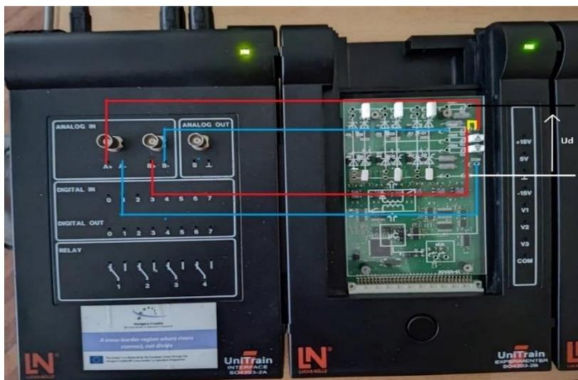
Sl. 4.24. Shema spajanja za mjerenje  $u-i$  karakteristike
