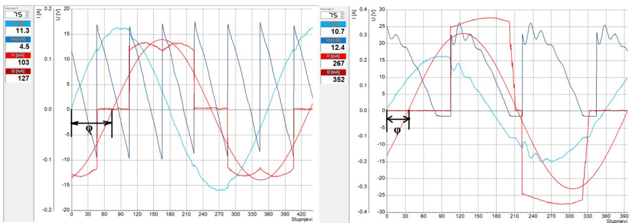
Sl. 5.2. Valni oblici karakterističnih napona i struja punoupravljenog spoja (lijevo) i poluupravljenog spoja (desno) za kut  $75^\circ$ el.
