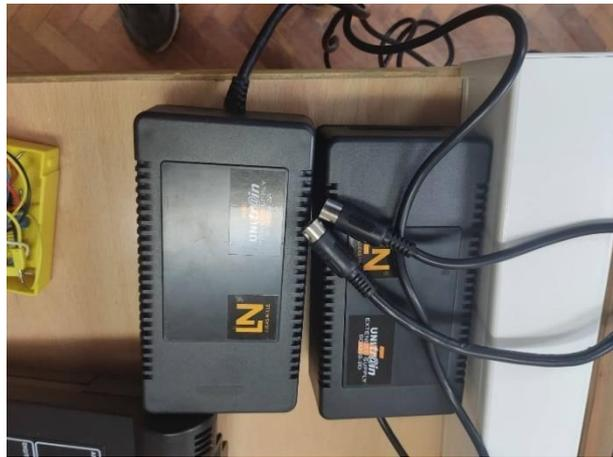
Sl. 4.5. Istosmjerno napajanje
