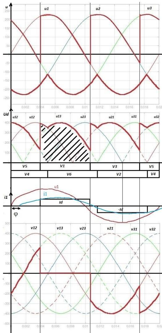
Sl. 3.7. Valni oblici karakterističnih napona i struja za kut kašnjenja okidanja  $45^\circ$
