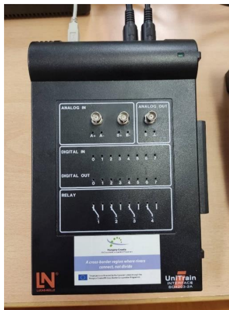
Sl. 4.2. Uni-Train mjerno sučelje
