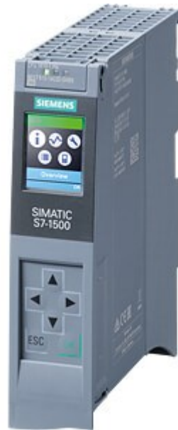
Slika 2.2. S7-1513-1 PN programabilni logički kontroler [3].
