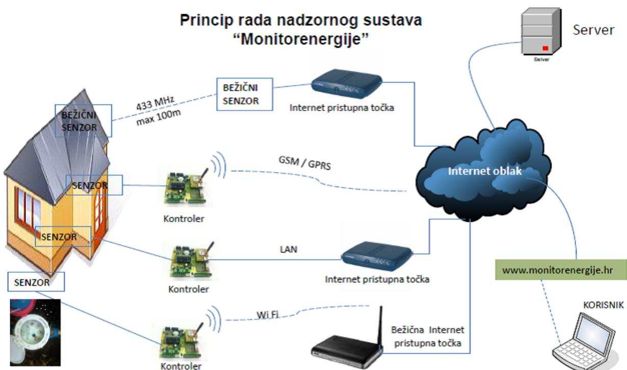
Slika 3.5. Princip rada nadzornog sustava Monitorenergije [30]
