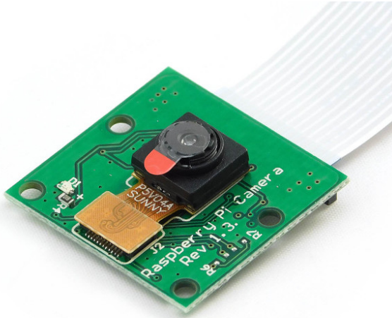
Slika 3.2: Raspberry Pi kamera verzije 1.3 korištena prilikom prikupljanja podataka u sklopu ovog diplomskog rada
