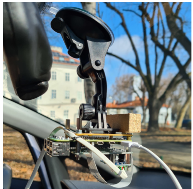
Slika 3.12: Montirani nosač sustava u automobilu Opel Corsa
