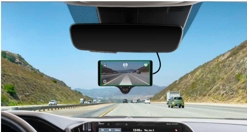
Slika 2.6: Comma Three uređaj montiran u automobilu[8]
