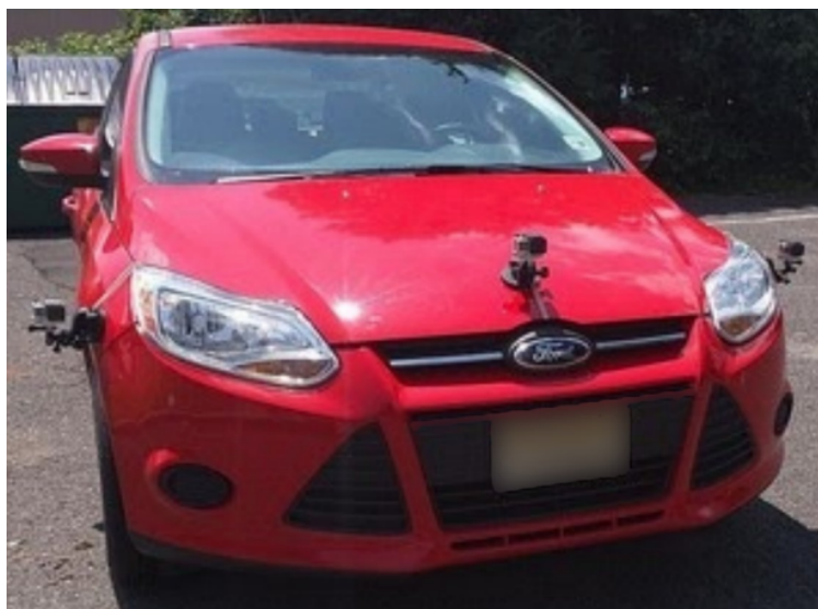
Slika 2.2: Prikaz pričvršćenih kamera korištenih u radu[5]
