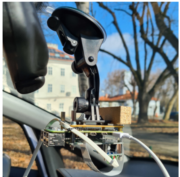
Slika 3.12: Montirani nosač sustava u automobilu Opel Corsa
