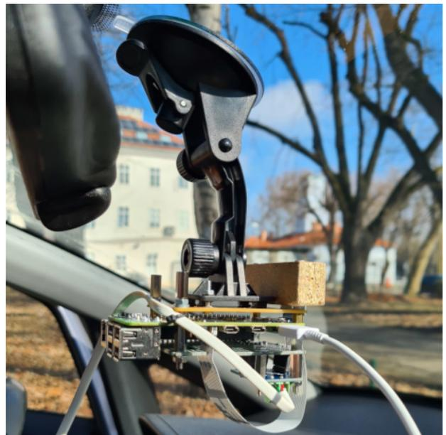
Slika 3.12: Montirani nosač sustava u automobilu Opel Corsa
