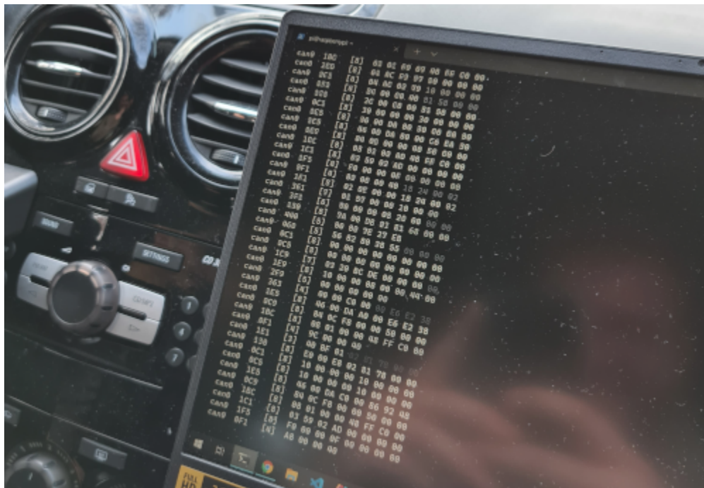
Slika 3.7: CAN poruke na zaslonu prijenosnog računala
