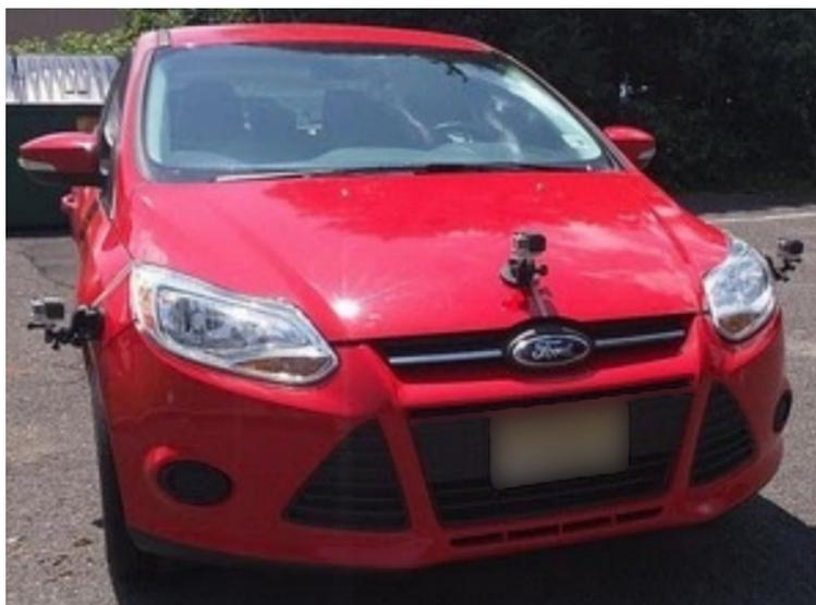
Slika 2.2: Prikaz pričvršćenih kamera korištenih u radu[5]
