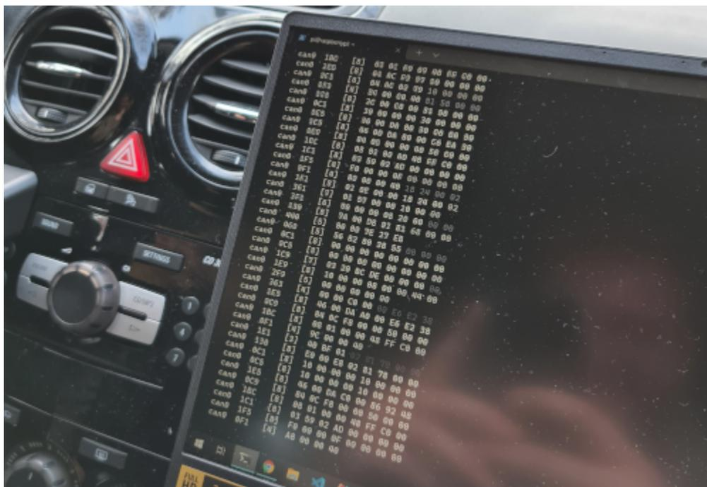
Slika 3.7: CAN poruke na zaslonu prijenosnog računala
