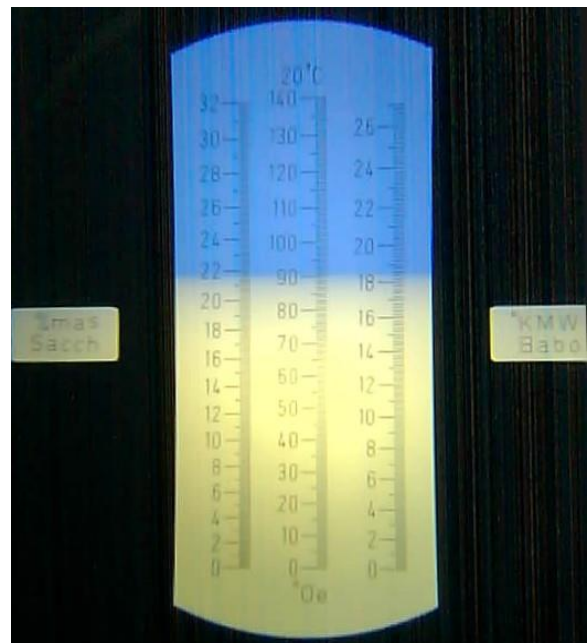
Slika 4.4. Skala refraktometra slikana uređajem
