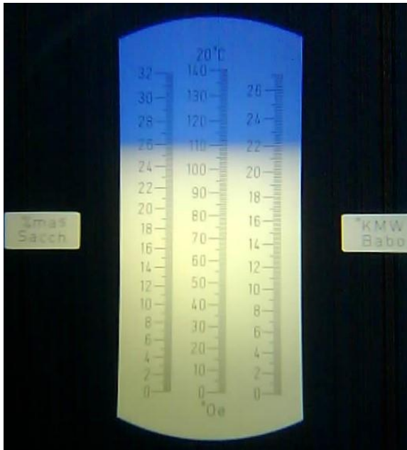
Slika 4.1. Skala refraktometra slikana uređajem
