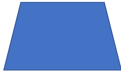
Slika 2.17. Distorzija snimane pravokutne površine
