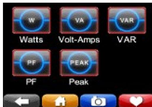
Slika 4.6 izbornik mjerenja snage i vršnih vrijednosti [2]
