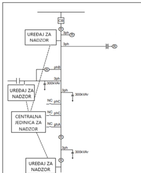
Slika 3.1 Prikaz nadzora kvalitete električne energije napojne mreže [1]
