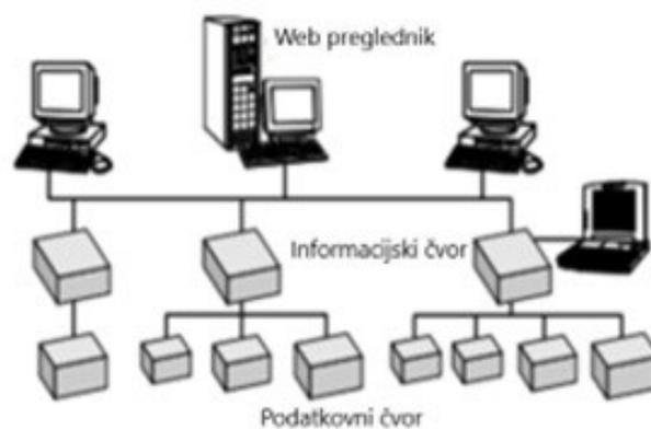
Slika 3.4 Arhitektura pametnog nadzora kvalitete električne energije [1]
