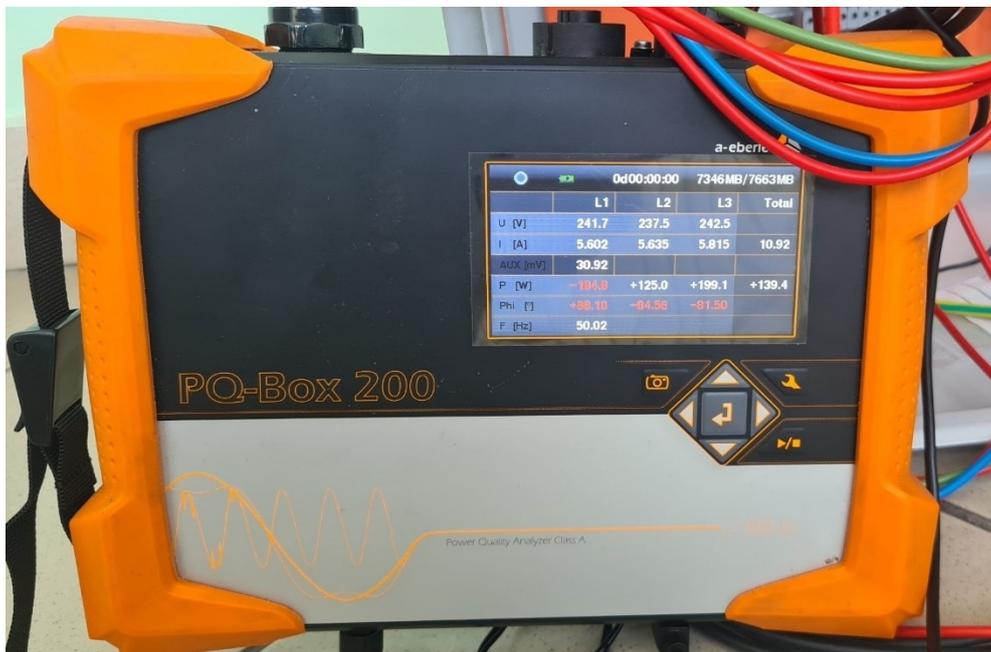
Slika 3.2 Prikaz mobilnog instrumenta za nadzor kvalitete PQ-Box 200
