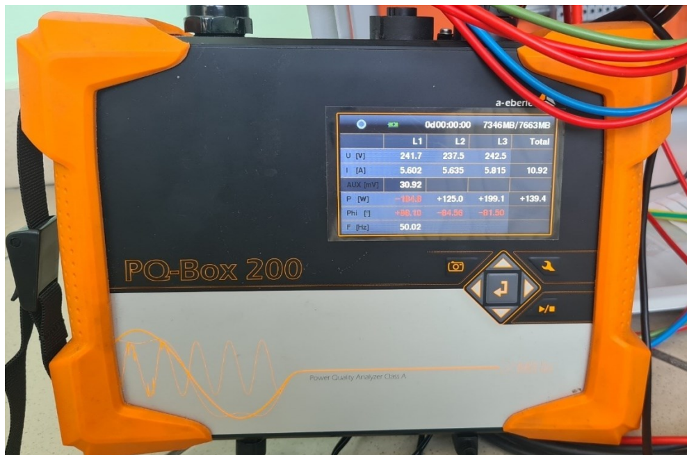
Slika 3.2 Prikaz mobilnog instrumenta za nadzor kvalitete PQ-Box 200
