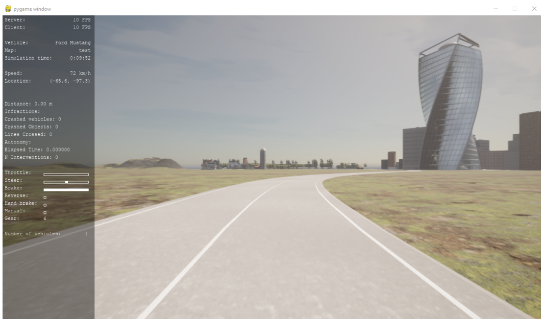
Slika 3.27: Grafičko sučelje u CARLA simulatoru s ispisom broja prelazaka kolničkih crta, broja intervencija, prijeđene udaljenosti i proteklog vremena
