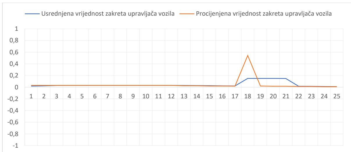
Sl. 3.27. Graf procijenjene vrijednosti zakreta upravljača vozila PilotNet mreže i implementirane usrednjene vrijednosti zakreta upravljača pri prolasku jednog zavoja ceste po broju okvira slika
