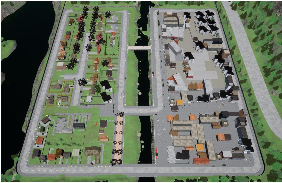
Sl. 3.21. Izgled mape Test3 načinjene u *Unreal Engine* alatu za testiranje implementiranog algoritma autonomne vožnje u obama simulatorima
