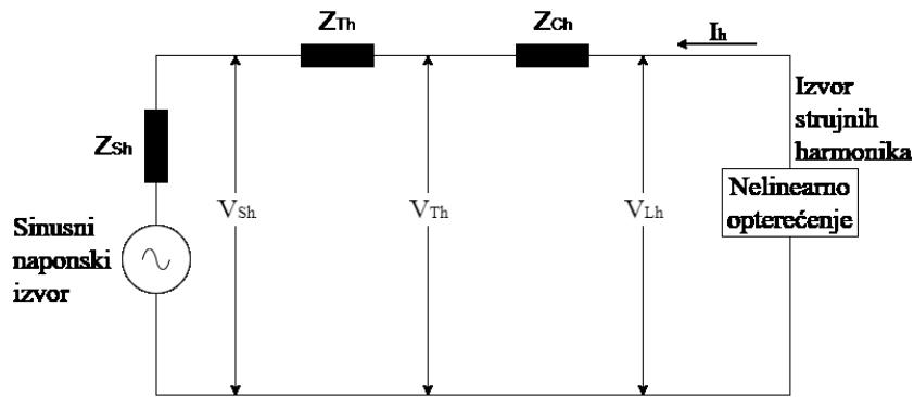
Slika 3.5. Harmonijski pad napona na impedanciji sustava [3]
