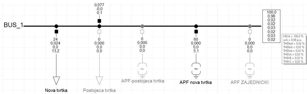
Slika 5.10. Harmonijska analiza novog industrijskog postrojenja i aktivnog filtera novog postrojenja
