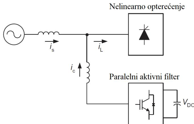
Slika 4.2. Osnovna shema aktivnog paralelnog filtera [21]
