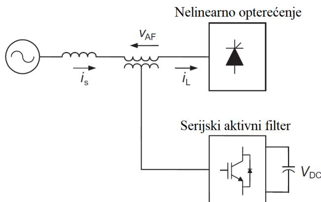
Slika 4.3. Osnovna shema aktivnog serijskog filtera [21]
